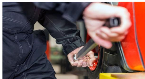
O torquímetro lida com o aperto final e vai nos dizer se o parafuso precisa de mais ou menos aperto para que se mantenha firme sem que exerça pressão demais, o que pode causar danos à peça na qual ele esteja fixado. Por isso, tenha em mente que você o utilizará somente para regular o torque.
